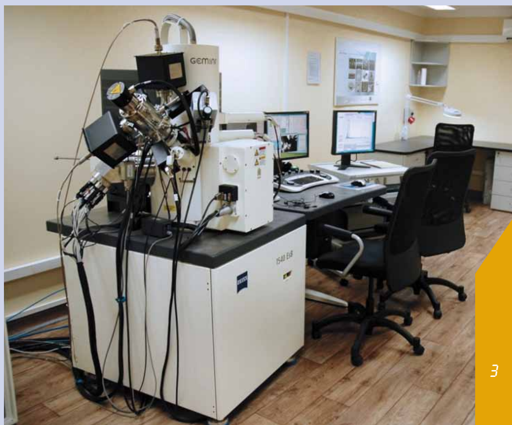
Skaningowy mikroskop elektronowy z działem jonowym (FIB) NEON 40EsB CrossBeam (ZEISS) z systemem mikroanalizy EDX Quantax 200 (Bruker)
