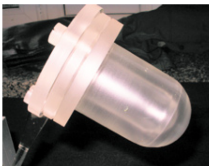
Stacyjny fantom serca – urządzenie wykorzystywane do kontroli jakości gamma kamer w szpitalnych zakładach medycyny nuklearnej
