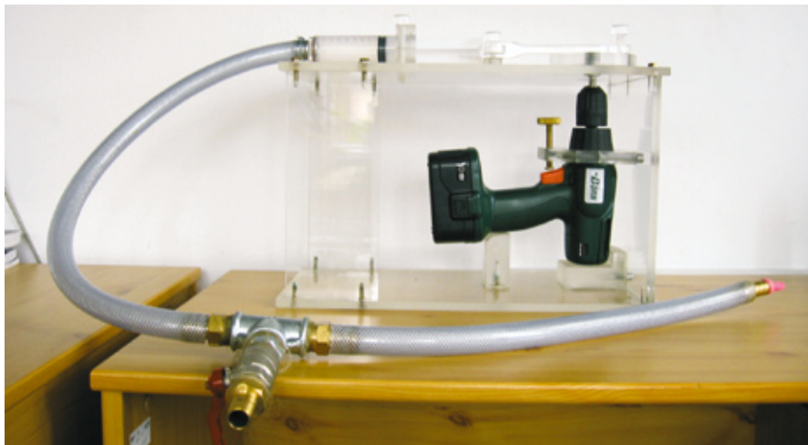
Dynamiczny fantom serca – urządzenie wykorzystywane do kontroli jakości gamma kamer w szpitalnych zakładach medycyny nuklearnej
